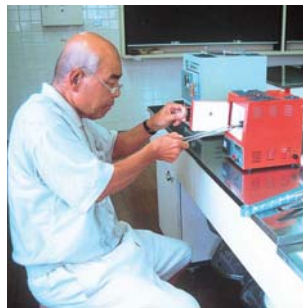
▲釉薬で色付けした後、850～900度の窯で1分ほど焼きます
