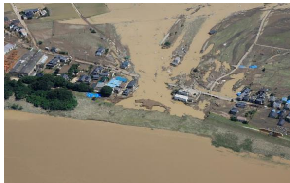
堤防決壊による家屋の流失(鬼怒川)
