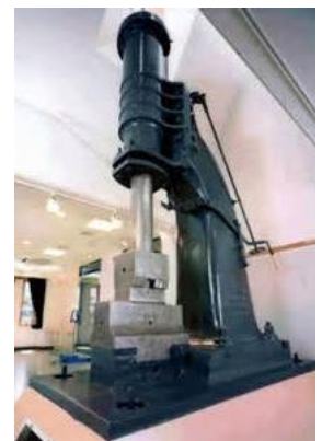
スチームハンマー-0.5t 片持型 横須賀製鉄所設置 1865年オランダ製
