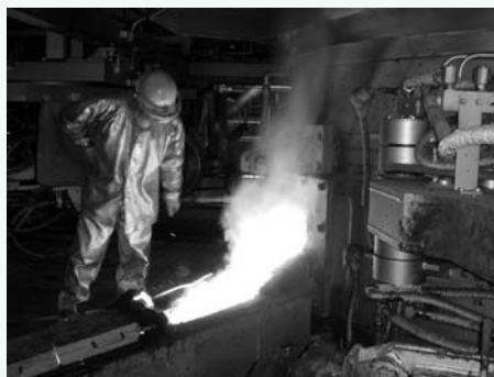
▲ 灰を溶かした炉から溶融メタルを取り出す様子
