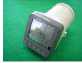
電離箱線量計
