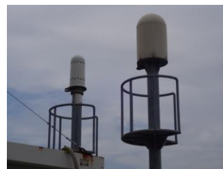
空間系検出器 (高線量率・低線量率)
