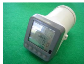
電離箱線量計
