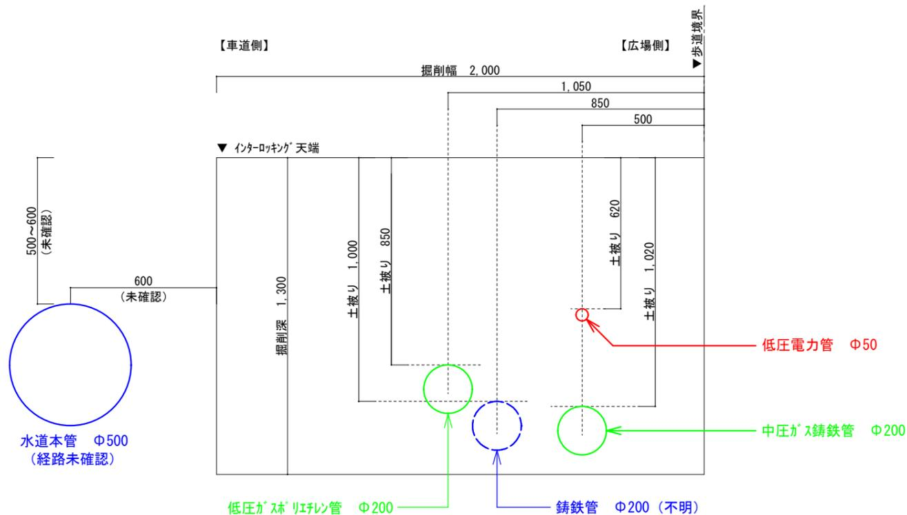
令和3年度埋設管調査断面図 1:20 (A3)
