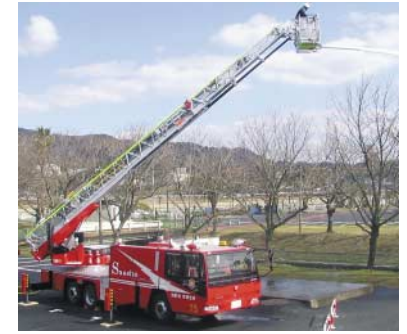
はしご先端のバスケットには、1分間に3,000ℓ放水可能な放水銃が装備されています。
