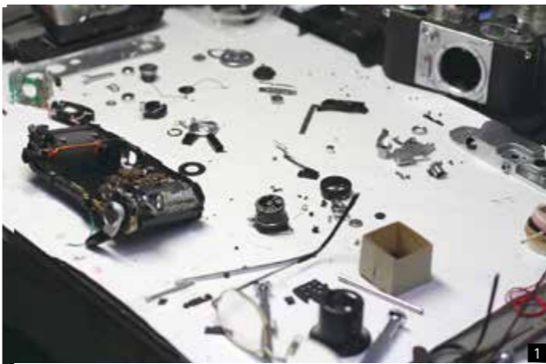
①分解された機械式のカメラ。ミリ単位の小さなパーツが並ぶ②接客中に修理品を確認する宮本さん③左目にルーペを付け、細かな作業を行う
