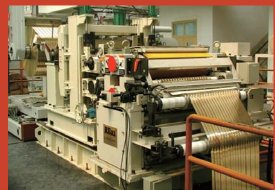
コイルセンターで帯状に切り分けられた金属板をコイル状に巻き直す工程の様子
