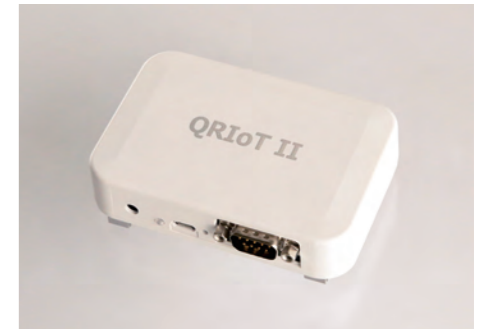
キュリオット 「IoT」技術を生かした自社製品「QRIO II」 (各種センサー情報をインターネットに送信 する装置)
