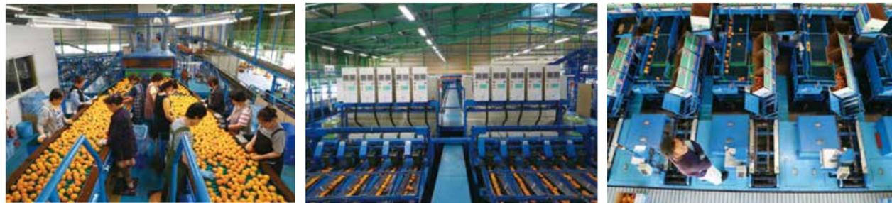
(写真上) 平成19年に完成した選果場。ラインは約100mあり、果実が傷つかないよう段差が少ない設計となっています(下左) ミカンの色や生傷の有無などを人の目で確認します(下中) 非破壊糖酸光センサーでミカンを傷つけることなく、1つずつ糖度と酸度を計測(下右) この日は「味まる」の箱詰めが行われていました
