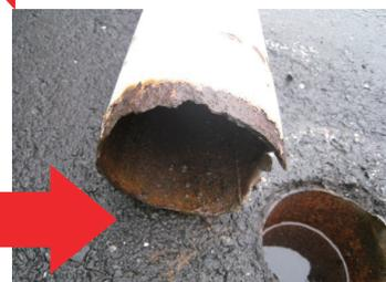
↑柱根元のサビを放置し、倒壊。
